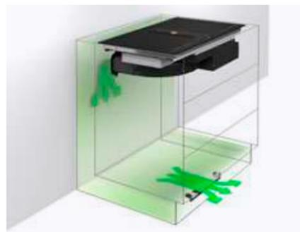
Questa particolare modalità è di fatto un'installazione in versione filtrante e con essa condivide tutte le caratteristiche di funzionamento, ma in questo caso l'evacuazione dell'aria avviene nello spazio di vuoto sanitario presente nella zona posteriore delle basi cucina invece di essere canalizzata altrove.
