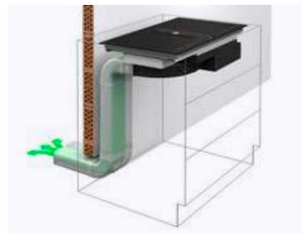
L'installazione in modalità aspirante consente di installare il piano con estrazione dei fumi all'esterno dell'abitazione; in questa modalità l'uscita dell'aria del prodotto vanno collegate al foro di uscita dell'abitazione o all'apposito canale di ventilazione, tramite tubazioni specifiche.
