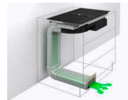
L'installazione in modalità filtrante consente di filtrare i fumi dai grassi e dagli odori di cottura e rimettere l'aria filtrata all'interno dell'abitazione, tramite specifiche tubazioni e griglie. È la modalità di installazione più attenta al risparmio energetico, in quanto tutta l'aria viene riciclata, evitando di trasferire calore all'esterno.
