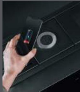
Disponibile in entrambe le finiture dell'acciaio, questo modulo sfrutta la tecnologia dell'induzione elettromagnetica per ricaricare wireless lo smartphone. È sufficiente appoggiarlo sopra il cerchio centrale per dare il via al processo di ricarica, che ha tempistiche paragonabili a quelle dei caricabatterie a filo tradizionali. (Compatibile con smartphone predisposti per ricarica wireless)
